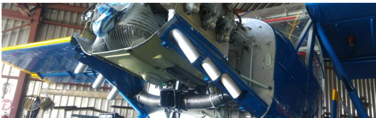
Obr. 2-3: Motor Praga Doris zespedu. Na snímku je vidět vzduchový vstup do karburátoru a chladič oleje.
