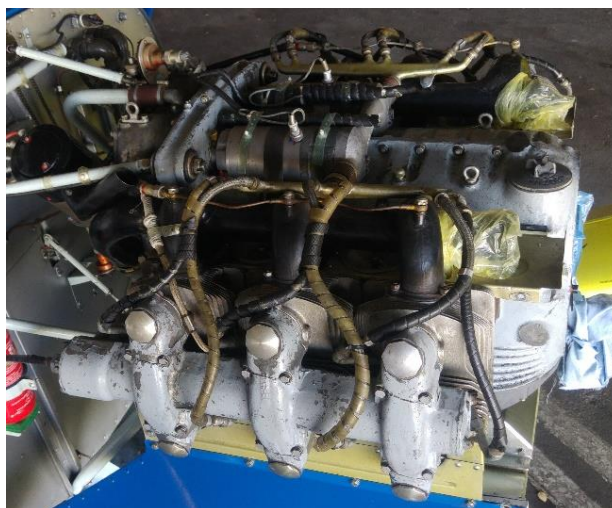
Obr. 2-2: Motor Praga Doris. Otvor pro plnění oleje na přední straně skříně.
