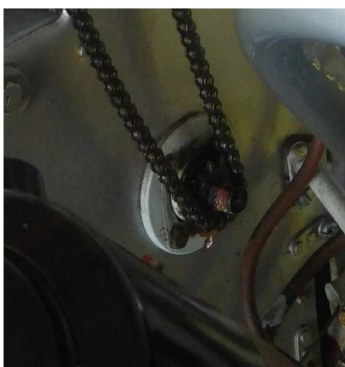
Obr. 2-27: Spodní úchyt řetězu. Z druhé strany přepážky je hřídel vedena do konzole ovládání.
