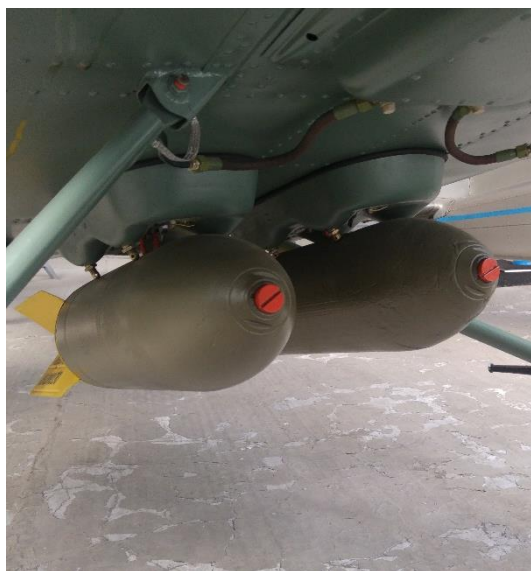
Obr. 1-5: Uchytení pum pod trupem K-60.
