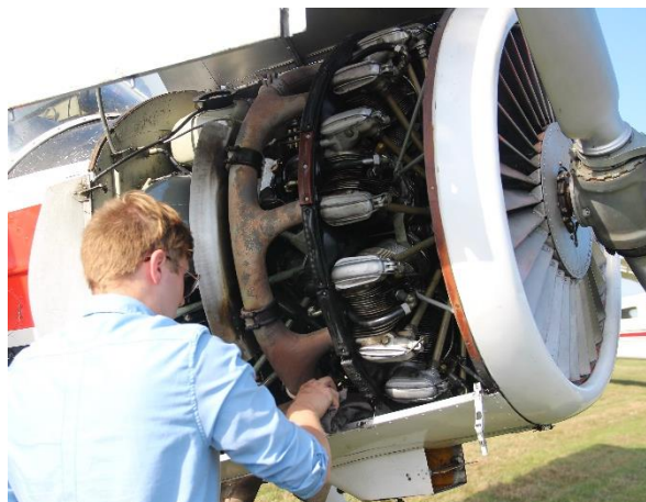
Obr. 2-13: Hvězdicový motor AI-14RA.
