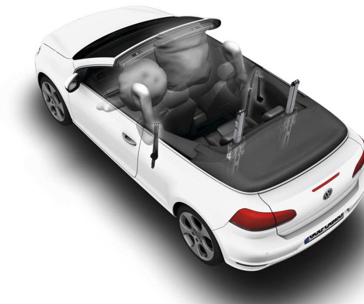
Obr. 17 Vysouvací rámy u vozidel bez střechy (VW)[40]
