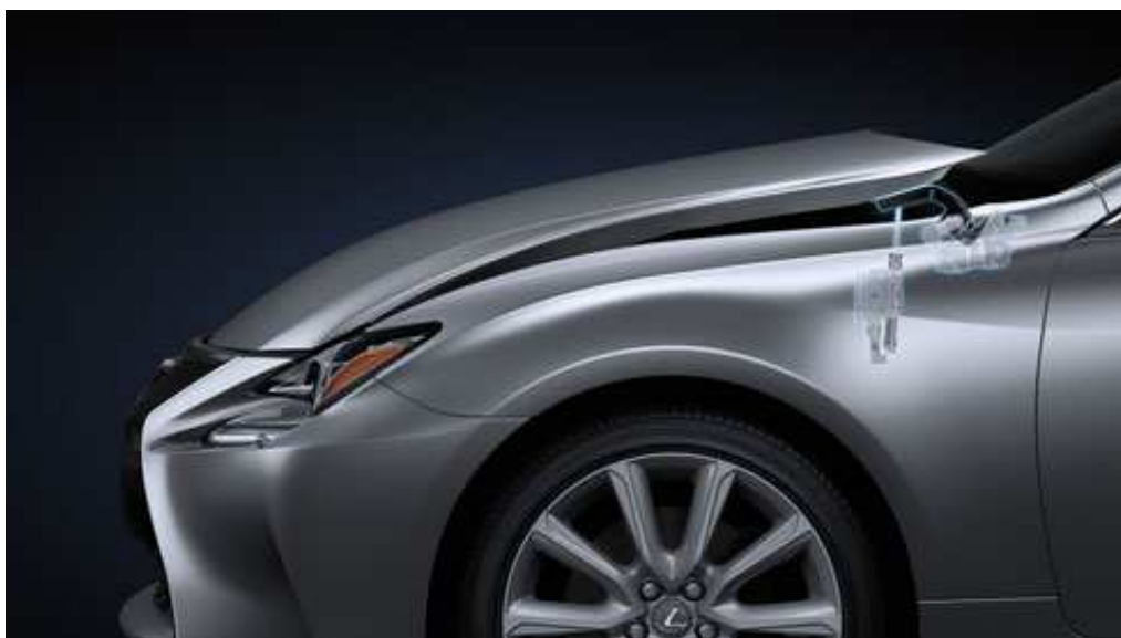
Obr. 16 Systém zvednutí kapoty u vozu Lexus RC[38]
