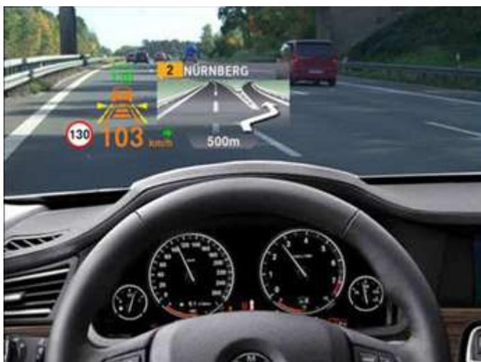
Obr. 10 Umístění HUD na čelním skle (BMW)[21]
