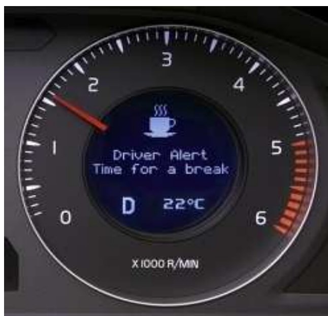
Obr. 12 Zobrazení doporučení na přestávku[23]
