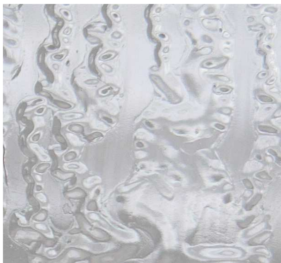
Obr. 4.4 PUR nátěr po 30 minutovém působení rozpouštědla TOU
