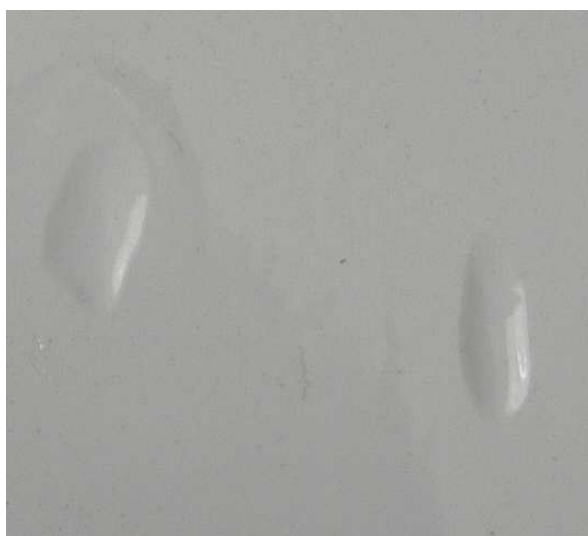
Obr. 4.6 PUR nátěr po 60 minutovém působení rozpouštědla 1,3 dioxolan
