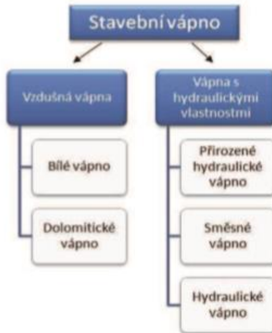
Obr. 6: Rozdělení stavebního vápna
