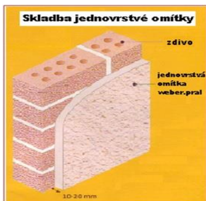
Obr. 3: Skladba jednovrstvé omítky [24]
