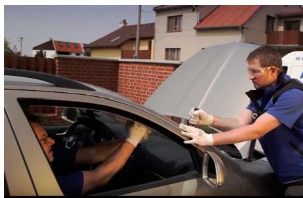
Obr. 23- - Výstřížek 3, oddělení autoskla od karoserie (22)
