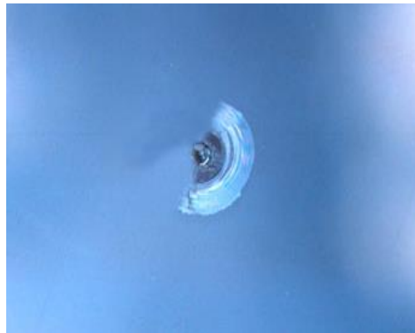
Obr. 38- Tvar poškození- půlměsíc (27)
