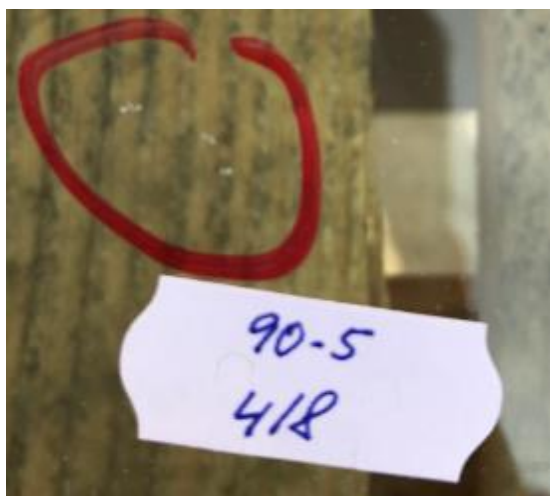
Obr. 112- místo střetu po dopadu kamene 90-4/8-5 (15)
