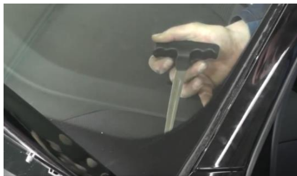
Obr. 20- Výstřížek 2, proniknutí do interiéru pomocí nože (22)
