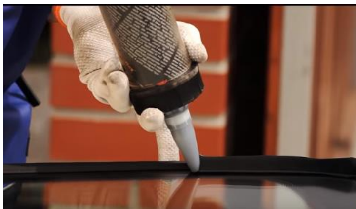
Obr. 27- Výstřižek 8, nanášení lepidla na nové čelní sklo (22)
