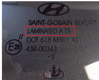
Obr. 17- Značení laminátového skla na štítku čelního skla (20)
