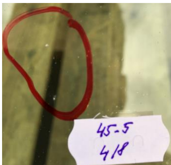
Obr. 87- místo středu po dopadu kamene 45-4/8-5 (15)
