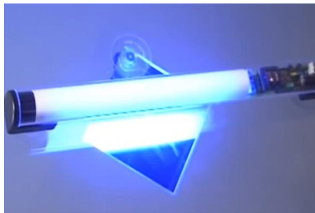
Obr. 61- Výstřižek 13- vytvrzení UV lampou
