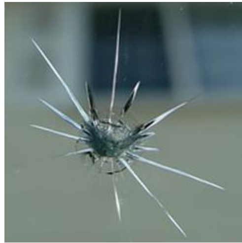
Obr. 40- Tvar poškození- hvězdicové (28)
