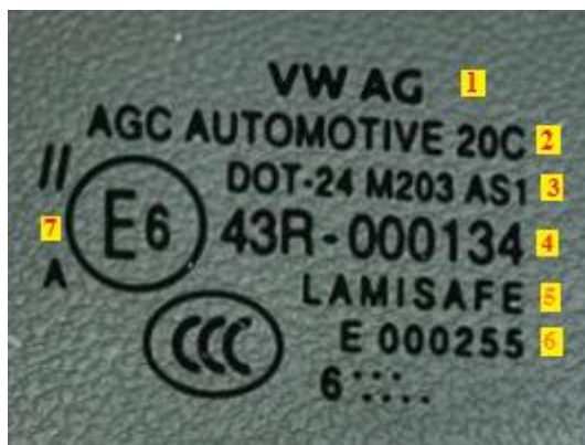
Obr. 31- Homologační štítek čelního skla Škoda Rapid r.v. 2015 (15)
