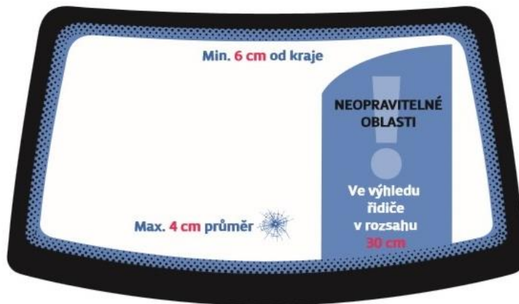
Obr. 48- Zorné pole řidiče, oblast nemožné opravy autoskla (30)
