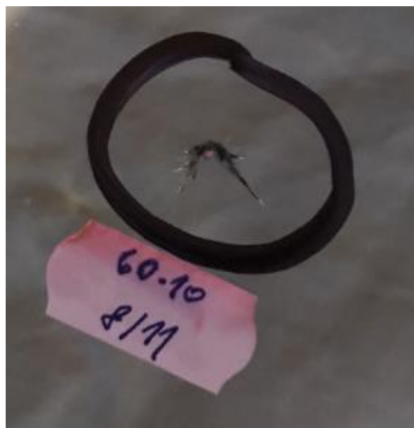
Obr. 103- místo dopadu po vyleštění kamene 60-8/11-10 (15)
