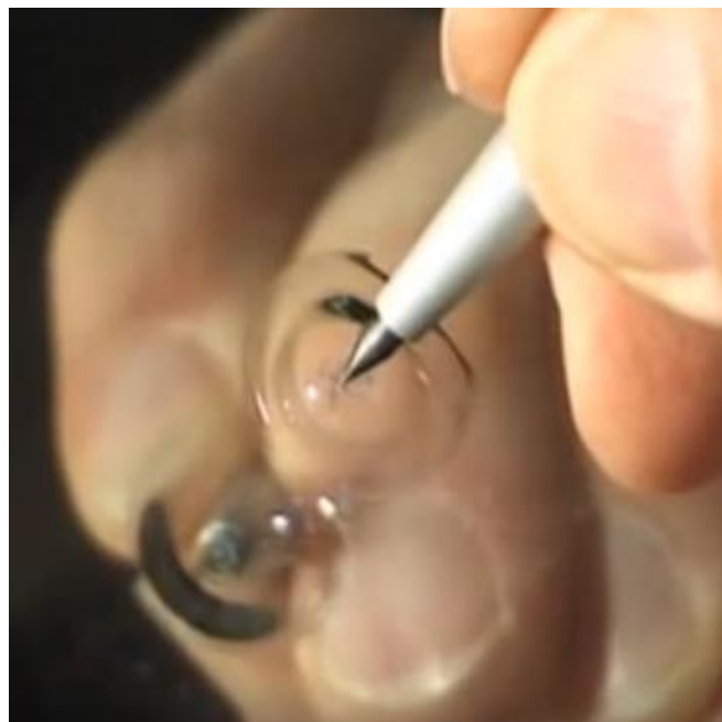
Obr. 50- Výstřižek 2- vyčištění kráteru po dopadu kamene (31)
