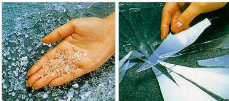
Obr. 4- rozbité jednoduché jednovrstvé sklo
