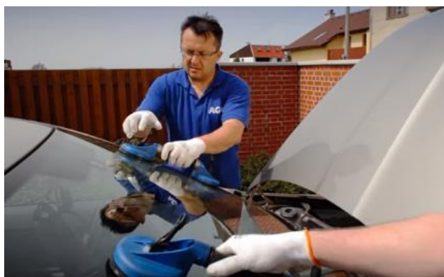
Obr. 24- Výstřížek 5, vyjmutí čelního skla z karoserie (22)
