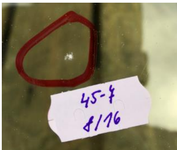
Obr. 93- místo střetu po dopadu kamene 45-8/16-7 (15)
