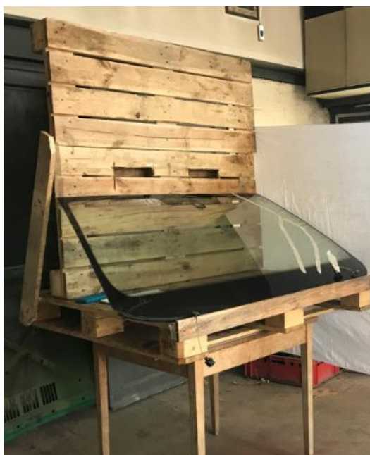
Obr. 67- Konstrukce pro uložení skla (15)
