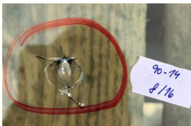
Obr. 117- místo střetu po dopadu kamene 90-8/16-14 (15)
