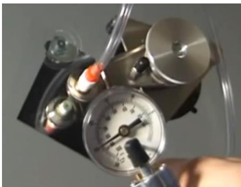
Obr. 58- Výstřížek 10- vysátí přebytečného vzduchu (31)
