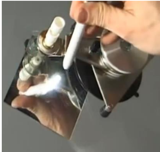
Obr. 60- Výstřižek 12- kontrola vytlačeného vzduchu (31)
