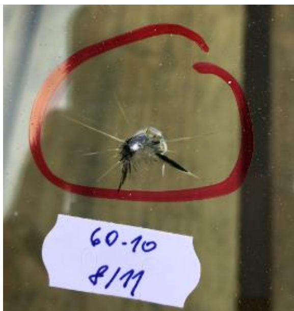
Obr. 102- místo střetu po dopadu kamene 60-8/11-10 (15)
