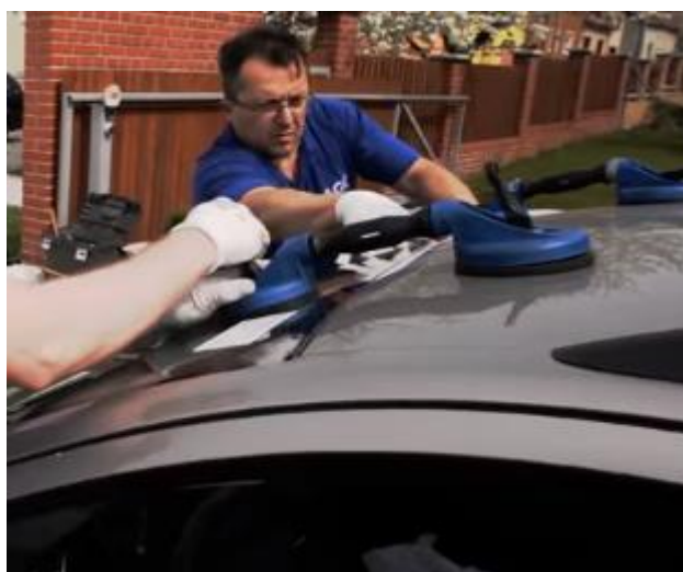
Obr. 29- Výstřížek 10, fixace čelního skla ke karoserii po dobu tuhnutí (22)
