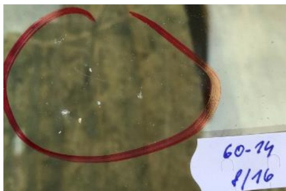
Obr. 106- místo střetu po dopadu kamene 60-8/16-14 (15)
