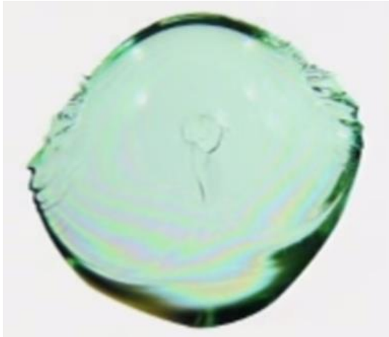
Obr. 36- Tvar poškození- kravské oko (24)
