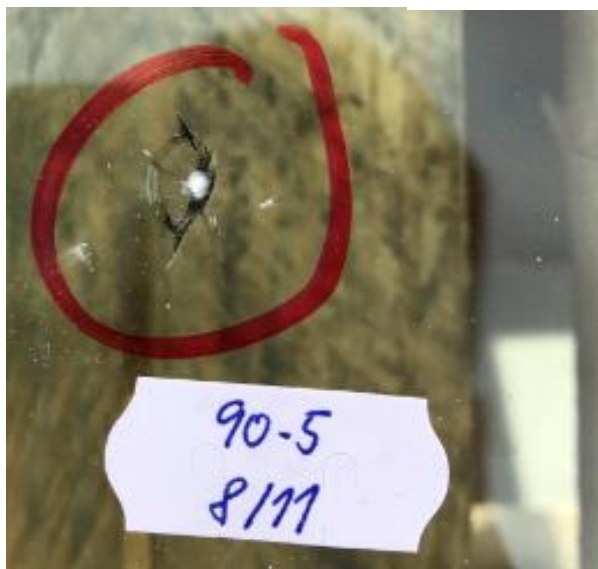
Obr. 114- místo střetu po dopadu kamene 90-8/11-5 (15)
