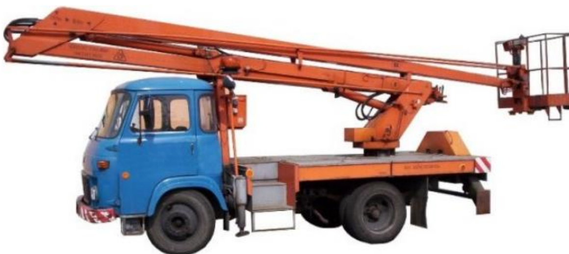
Obr. 64- Vozidlo Avia MP-16 s plošinou PM0160 A31.1N (33)
