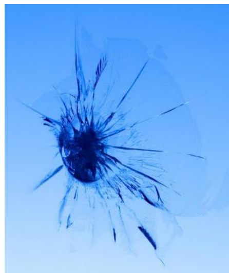
Obr. 41- Tvar poškození- tříštvé (27)
