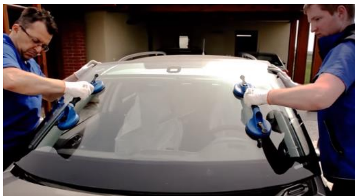
Obr. 28- Výstřížek 9, montáž čelního skla do karoserie (22)
