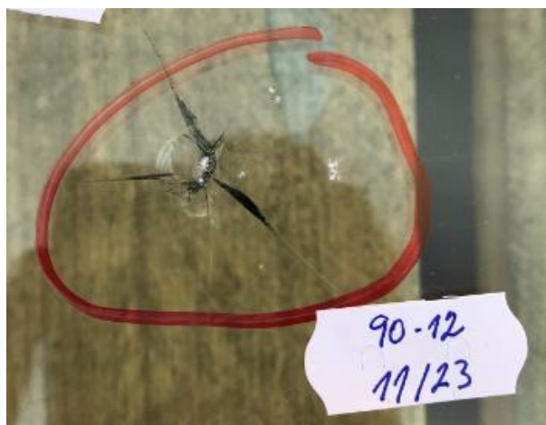
Obr. 121- - místo střetu po dopadu kamene 90-11/23-12 (15)
