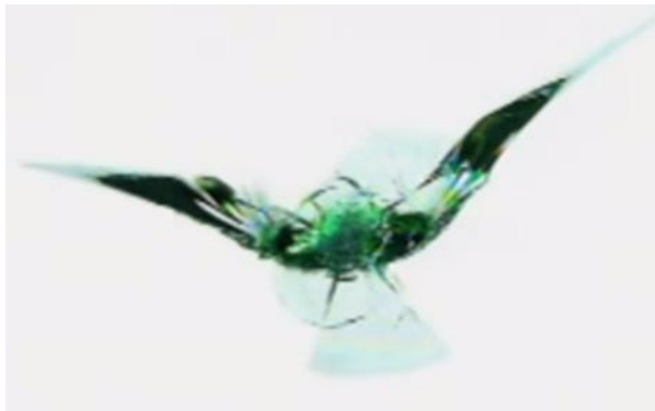
Obr. 43- Tvar poškození- včelí křídla (25)
