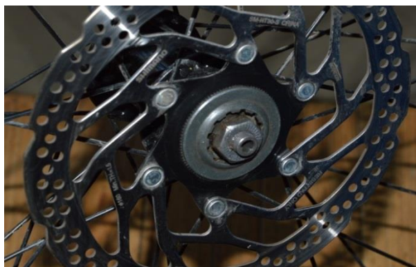
Obr. 11 Centrlock systém upínání kotouče[22]
