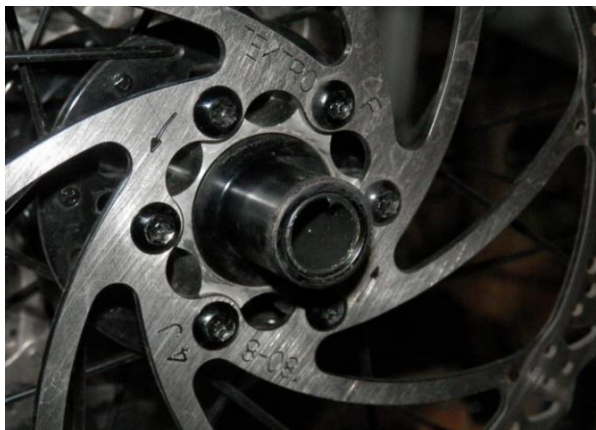
Obr. 10 Upnutí kotouče pomocí šestice šroubů [22]
