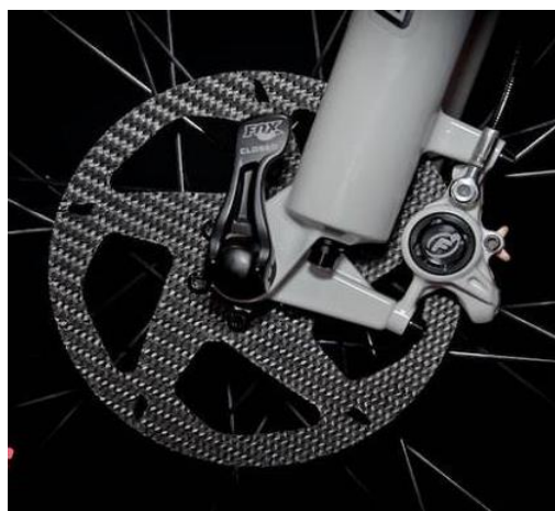
Obr. 21 Karbon-keramický kotouč SiCCC [36]
