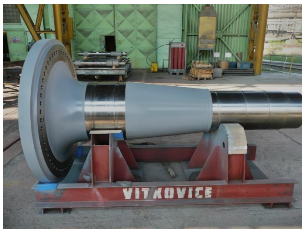
Obr. 2 Nanášení žárových nástřiků [6]
