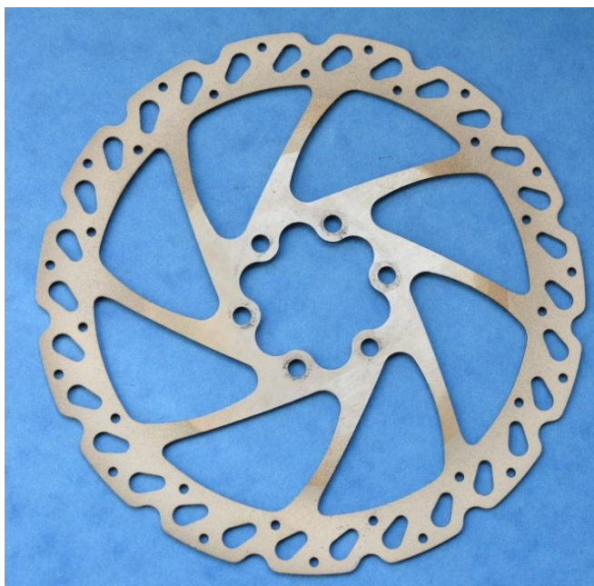
Obr. 41 Brzdový kotouč po nanesení povlaku
