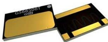
Obr. 2-3: Speciální SMD pouzdro tranzistoru GS66508T, rozměry cca 7x4,5x0,5 mm.
