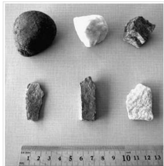
Obrázek 9: Tvary (podle BS 812: 1989) jsou ve směru hodinových ručiček zleva shora: Zaoblené, nepravidelné, úhlové, vločkané, protáhlé, vločkané + protáhlé.
