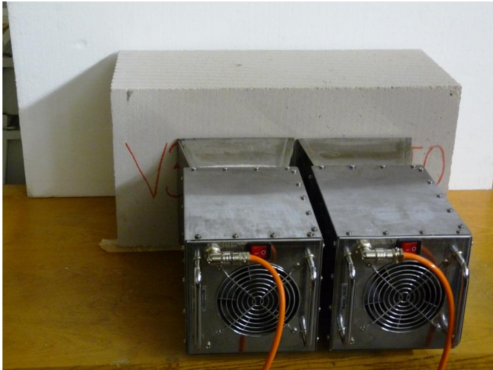
Obr. 15: Ozařování pórobetonu s přístroji MG elektronik MB
