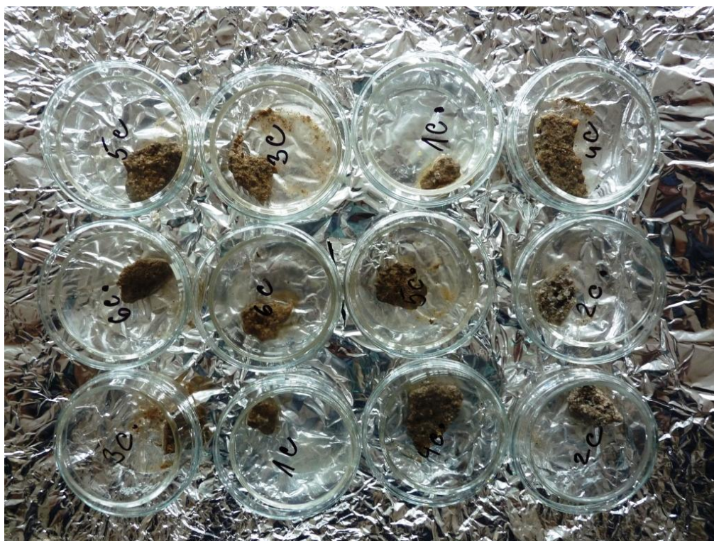
Obr. 28: Vzorky nárůstů plísní na vzorcích vápenocementové omítky uložené v Petriho miskách
