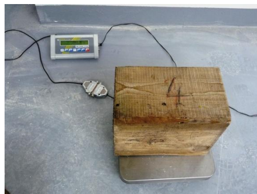
Obr. 23, 24: Hmotnost vzorku s exteriérovou vlhkostí a vzorku po dlouhodobém namoření
