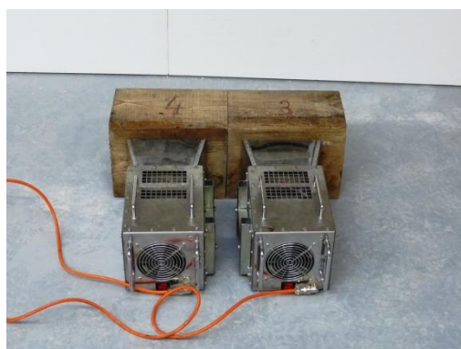
Obr. 25, 26: Vysušování vzorků s absorbovanou relativní vlhkostí vzduchu exteriéru a vzorků po namoření
