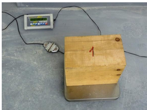
Obr. 23, 24: Hmotnost vzorku s exteriérovou vlhkostí a vzorku po dlouhodobém namoření
