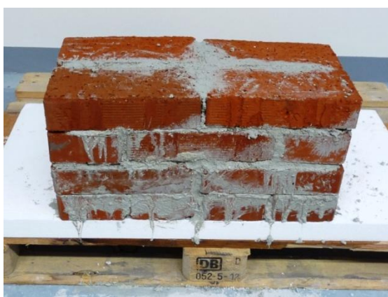
Obr. 8 a 9: Namočení cihel a vyzdění pilíře 600x300x240 mm
