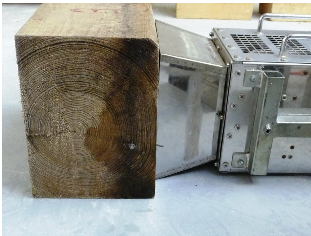
Obr. 27: Ozařovaný prvek č. 3 po prvním 30-ti minutovém ohřevu
