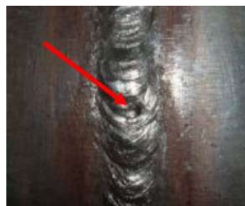
Obr. 4.1 Dutina ve svaru [32]
