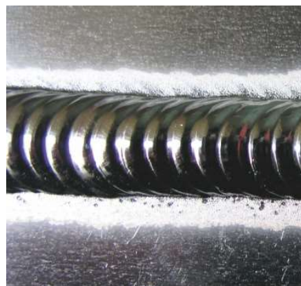
Obr. 3.4 Svar v pulsním režimu [27]
