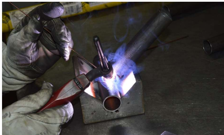
Obr. 5.4 Svařování vzorku metodou TIG
