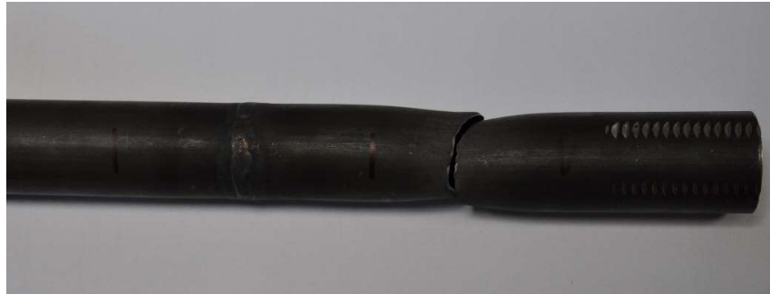
Obr. 5.20 Přetržení celistvé trubky
