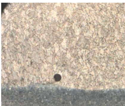
Obr. 4.2 Vměstek ve svaru
