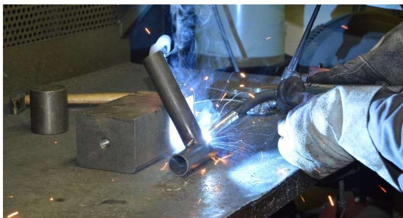
Obr. 5.3 Svařování vzorku metodou MAG
