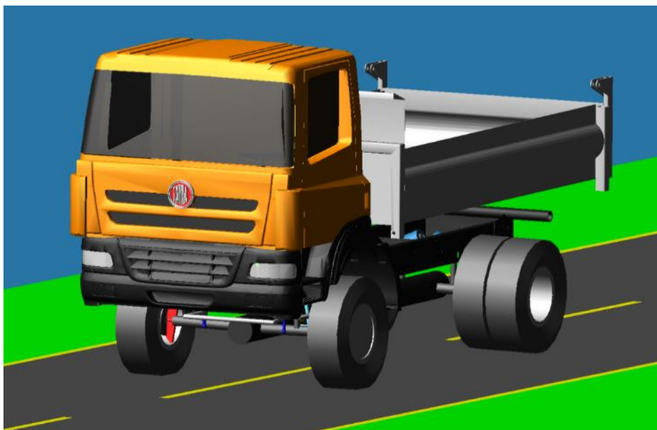
Obr. 2 Kompletní model vozidla Tatra T158 4x4.2 v prostředí MSC ADAMS Car
