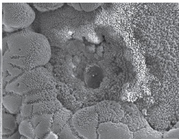
Obr. 7 Pohled zblízka na otvor trysky vstřikovače [6]
