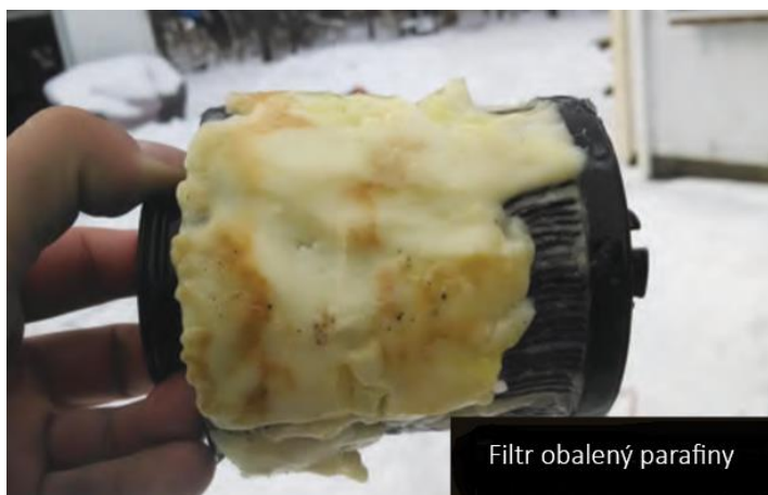
Obr. 5 Palivový filtr obalený parafíny [27]
