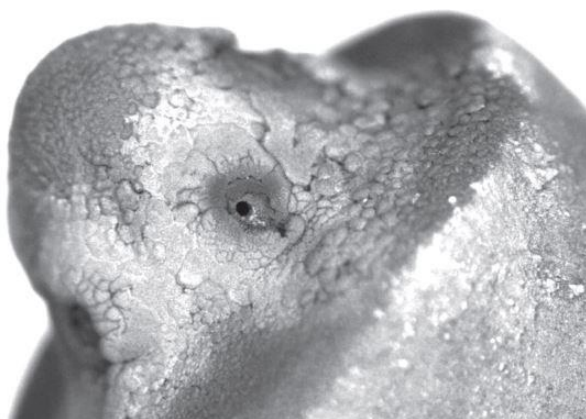
Obr. 6 Usazeniny na špičce diesellového vstřikovače [6]
