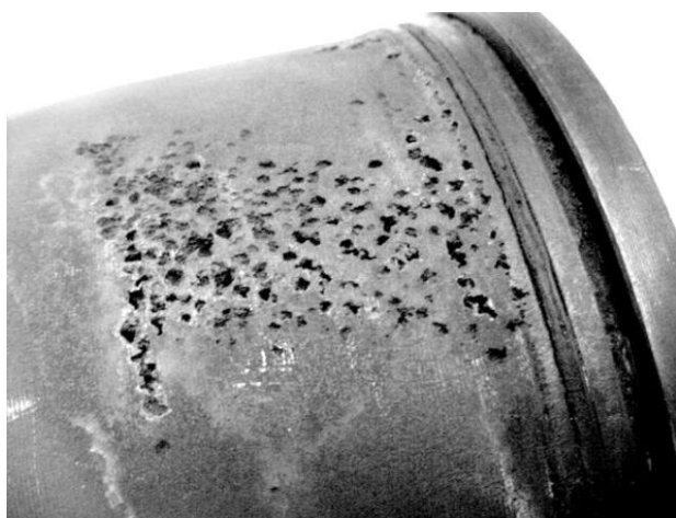
Obr. 25 Kavitační opotřebení pouzdra válce spalovacího motoru [40]
