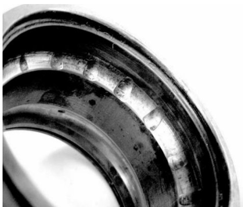
Obr. 27 Vibrační opotřebení valivého ložiska [40]
