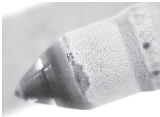
Obr. 8 Usazeniny sodíku na jehle naftového vstřikovače [6]
