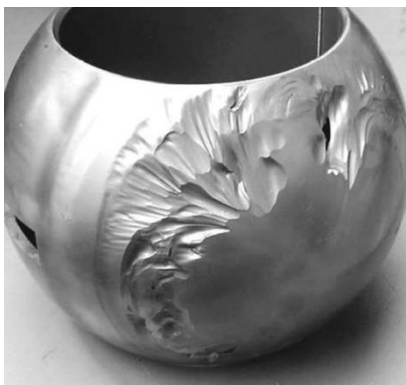
Obr. 24 Ukázka erozivního opotřebení [40]
