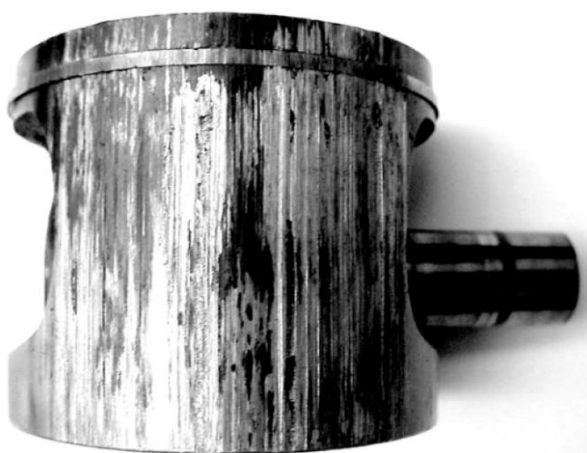
Obr. 23 Abrazivní opotřebení pístu spal. motoru [40]
