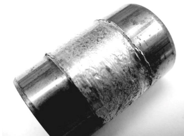
Obr. 21 Adhezivní opotřebení píst. čepu [40]
