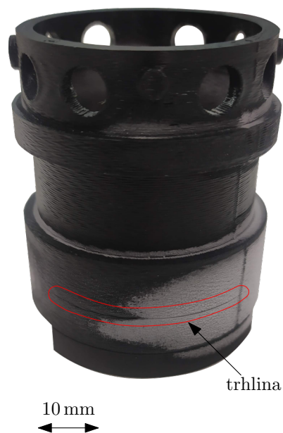
Obr. 4.3: Cyklická skúška tepelného zaťažovania dielov vyrobených aditívnou výrobou, ochladzovaním v tekutom dusíku.
