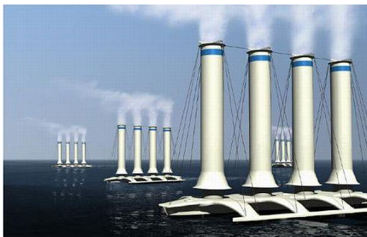
Obr 21 Návrh systému pro injektáž MCB [91]
