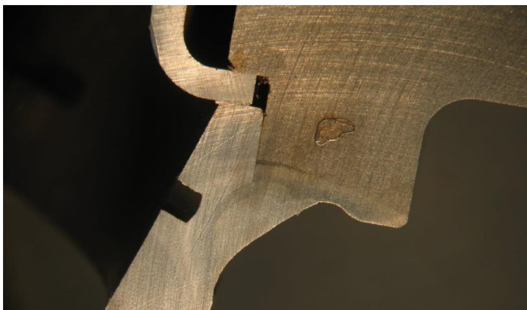
Obr. 90 Výbrus svarového spoje ramene s přírubou ojnicího čepu [ŠKODA AUTO]
