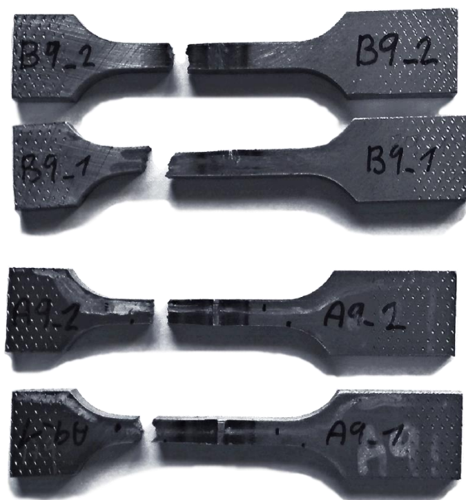
Obr. 86 Zkušební vzorky svarového spoje po tahové zkoušce [ŠKODA AUTO]
