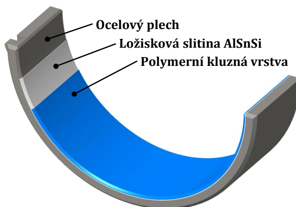
Obr. 9 Pánev hlavního ložiska s polymerní povrchovou kluznou vrstvou
