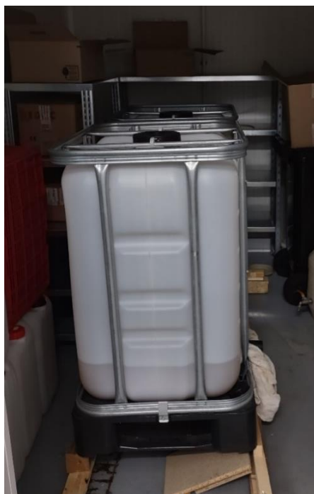
obr. 24 IBC kontejnery s odpaní vodou [vlastní zdroj]
