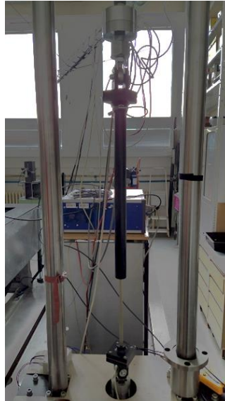
Obr. 6-22 Testovanie na pulzátore Inova.
