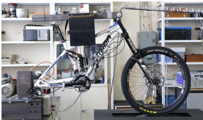
Obr. 6-28 Overenie funkčnosti stanici Dynotec.
