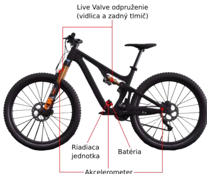
Obr. 2-10 EH systém odpruženia Fox Live Valve [33].
