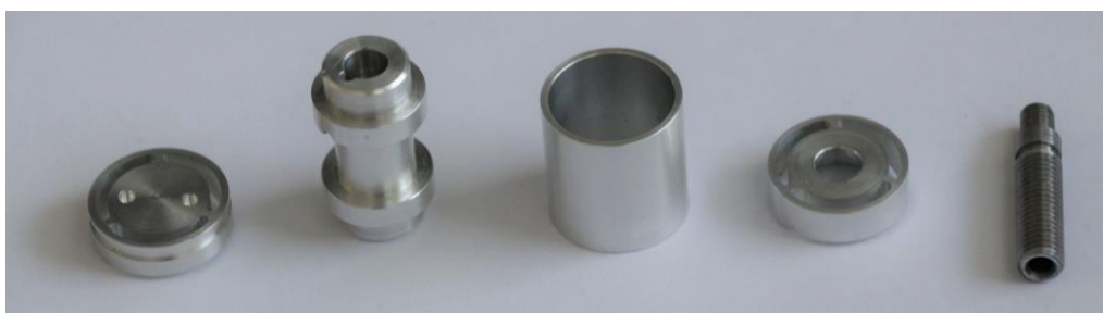
Obr. 6-4 Skúšobná vzorka MR piestu.
