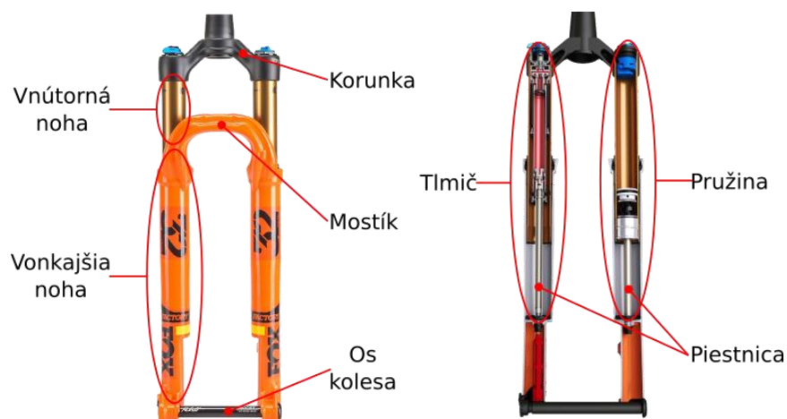
Obr. 2-3 Konštrukcia teleskopickkej vidlice [15].
