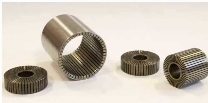
Obr. 2-19 Upravený tvar jadra a vonkajšieho obalu MR piestu [45].
