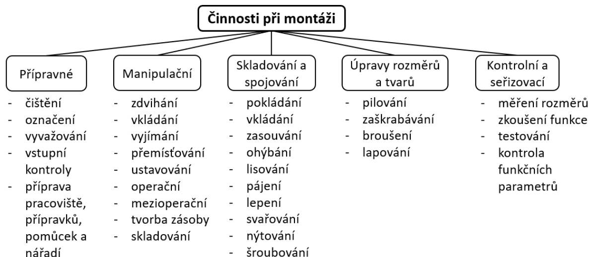
Obr. 12 Druhy a rozdělení činností při montáži – podle [7; 8; 9; 13].
