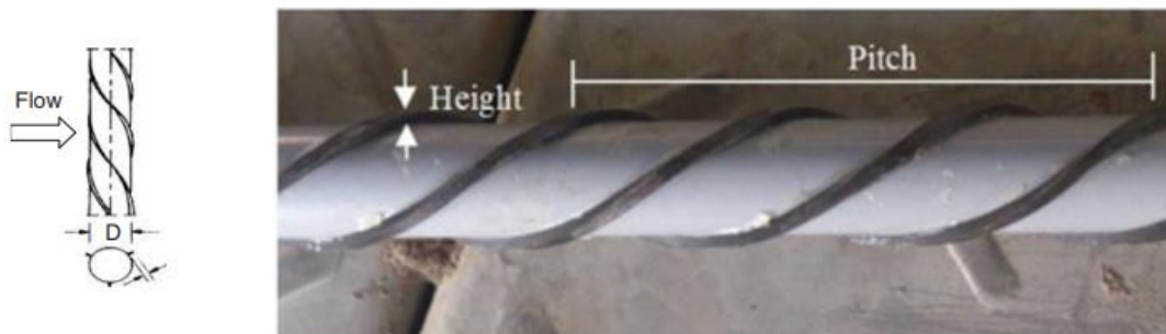
Obr. č. 14 – Geometrie válcového tělesa s vinutou spirálou. Převzato z [3] a [20]
