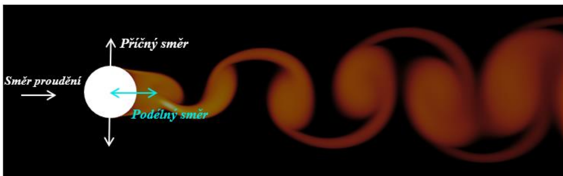
Obr. č. 2 – Ukázka části Kármánovy vírové stezky s vyznačením základních směrů buzení tělesa. Z CFD simulace v programu FLUENT. (Zdroj vlastní)
