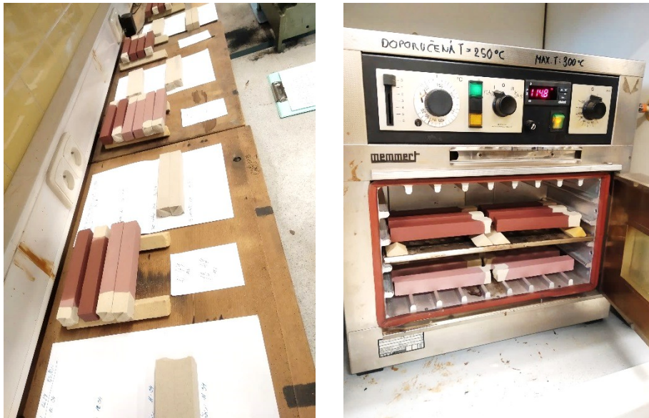
Obr. 29 Vzorky schnoucí na vzduchu (vlevo), vzorky sušené v sušičce (vpravo).
