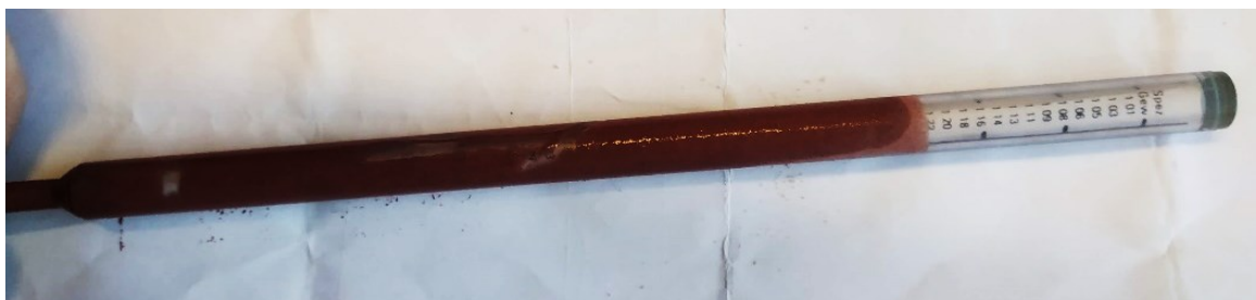
Obr. 28 Odečítání hustoty nátěru po naředění na 27 °Bé.
