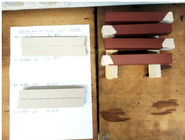
Obr. 30 Trámečky s nátěrem a bez připravené k měření pevnosti v ohybu.
