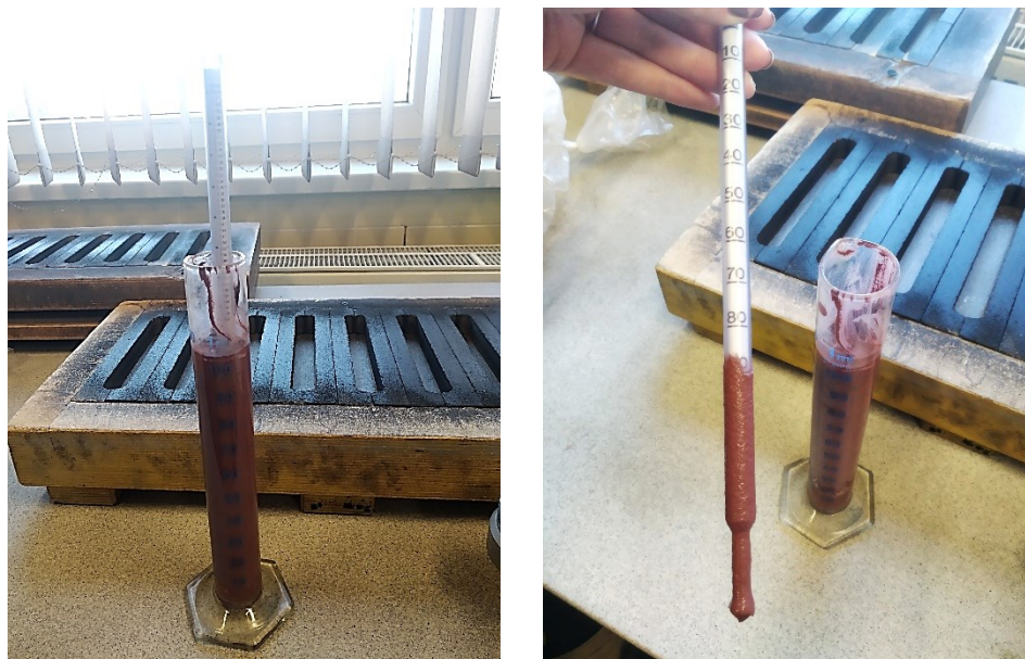
Obr. 27 Měření hustoty Baumé neředěného nátěru.
