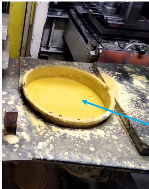
Obr. 8 Pracoviště pro ruční máčení jader v nátěru.
