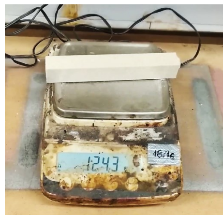
Obr. 17 Zkušební trámečky (vlevo), vážení zkušebního trámečku (vpravo).
