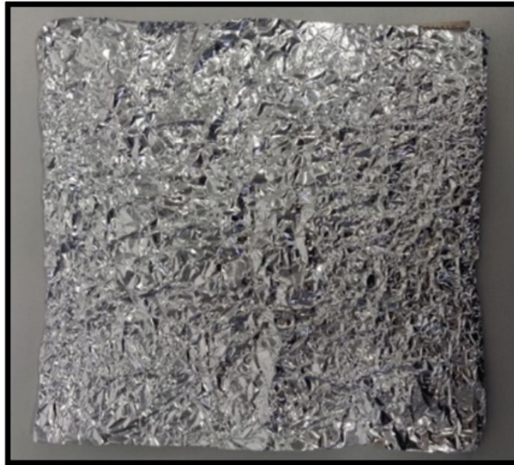
Obr. 37: Improvizovaný Lambertův zářič z hliníkové fólie.
