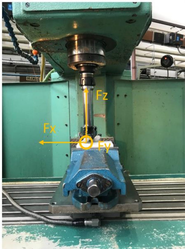
Obr. 91: Tribologický experiment se zaznačenými osami silového měření.
