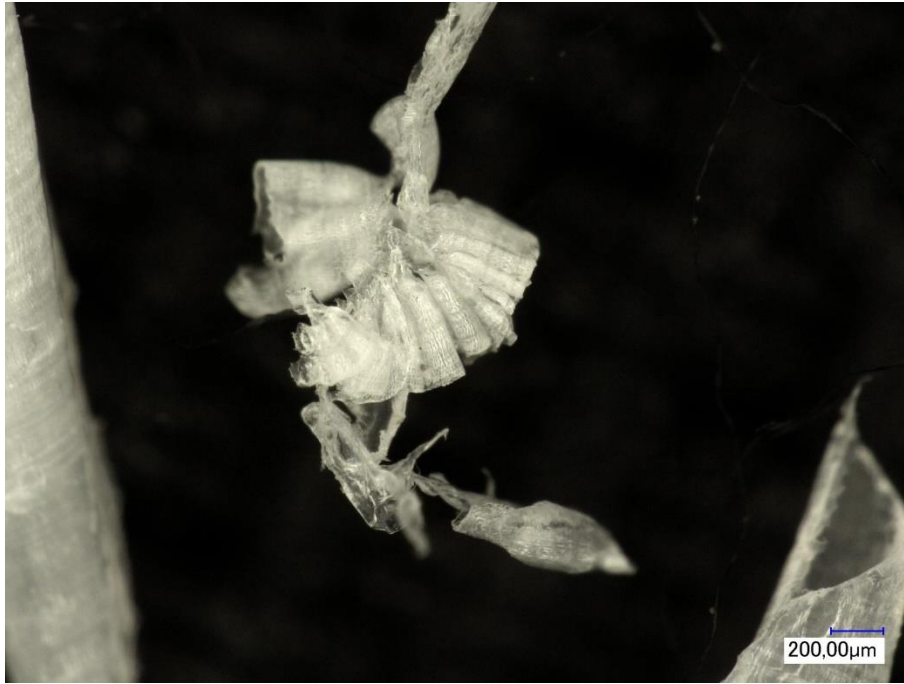
Obr. 48: Pěchování třísky při obrábění během 10 s.
