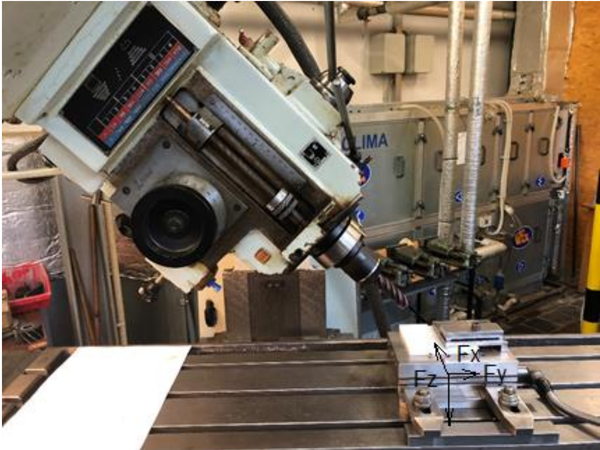
Obr. 32: Frézka s upnutým zkušebním vzorkem a snímačem Kistler 9257 B.
