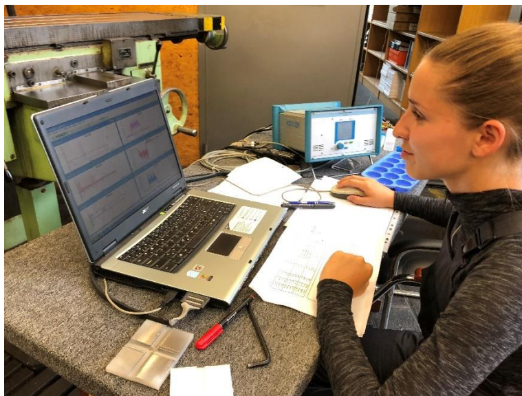
Obr. 92: Měření působících sil na dynamometru značky Kistler.
