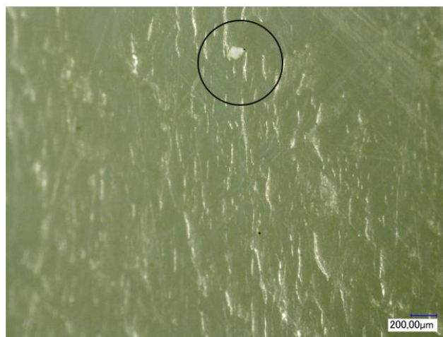
Obr. 119: Částice UHMWPE přilnutá k povrchu.
