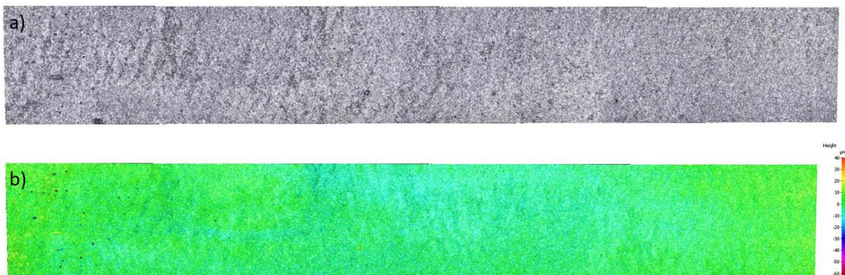
Obr. 86: Snímky povrchu po nahřátí ložiskem a) černobílý snímek, b) znázornění barevnou stupnicí.
