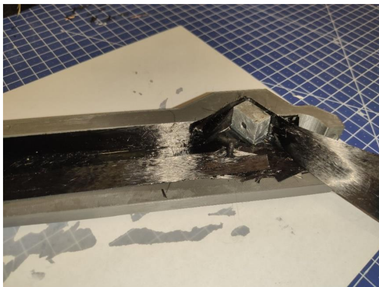
Obrázek 46 Laminace jednosměrné tkaniny
