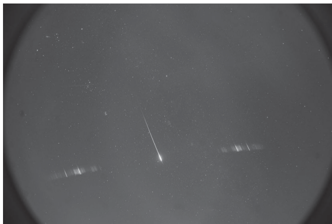
Obrázek 1.2: Spektrum meteoru zachycené fotoaparátem Canon EOS Mark II s rybím okem f/2,8 a ohniskovou vzdáleností 15 mm a mřížkou 1\,000\text{ mm}^{-1} . Převzato z [8, str. 330].
