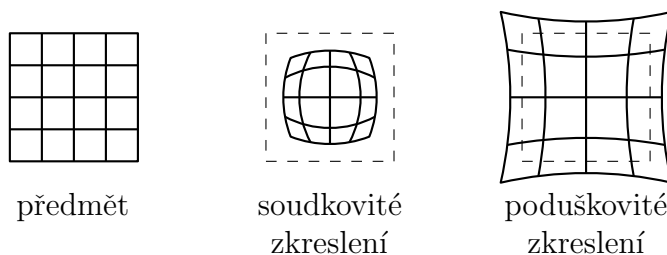
Obrázek 2.8: Dva typy zkreslení. U soudkovitého zkreslení dochází k poklesu zvětšení pro rostoucí pole, u poduškovitého naopak k růstu. Překresleno podle obrázku v [18, str. 40].
