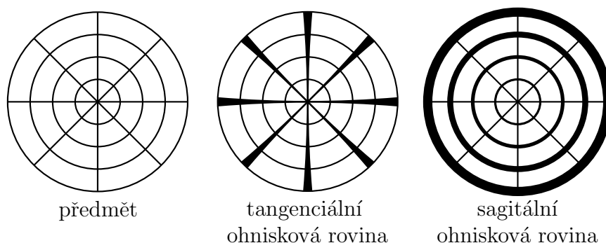
Obrázek 2.6: Projev astigmatismu. V tangenciální ohniskové rovině jsou ostré kroužky a rozmazané radiální úsečky, v sagitální ohniskové rovině je tomu naopak, tuto skutečnost lze domyslet z obr. 2.5. Překresleno podle obrázku v [17, str. 511].
