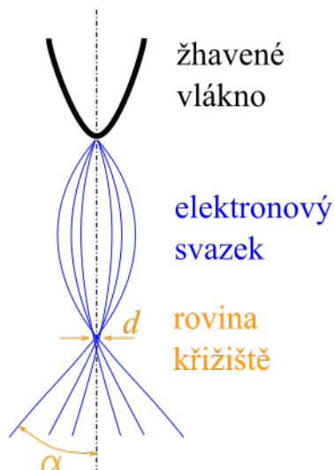
Obrázek 4.3: Znázornění roviny křižště a parametrů pro výpočet jasu zdroje.
