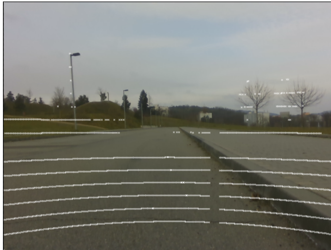
Obr. 2.1: Projekcia bodov PointClodu vykonaná metódou delenia
