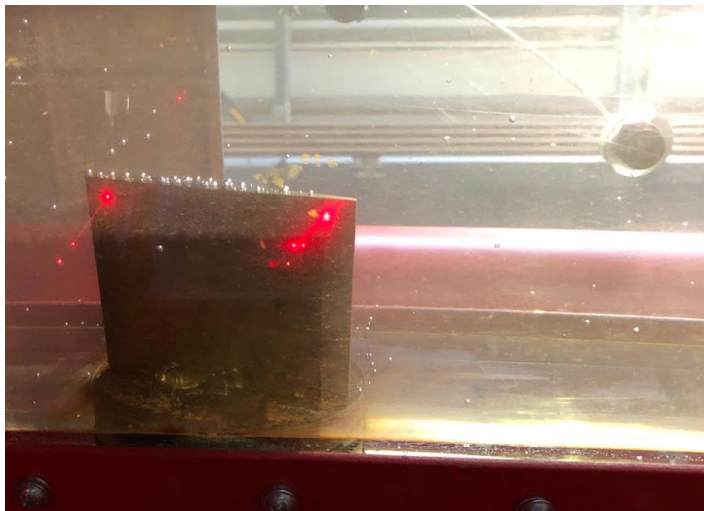
Obr. 5.5 – LDV měřící vibrace lopatky.
