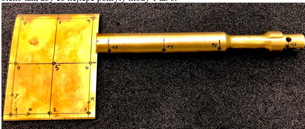
Obr. 5.10 – Rozvržení excitačních bodů na lopatce.
