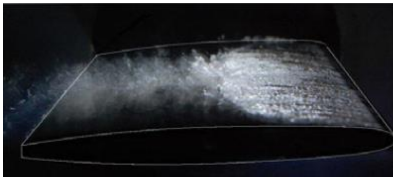
Obr. 2.6 – Kavitace vznikající na lopatce [16].
