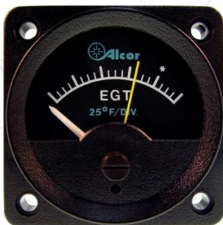
Obrázek 2.10 - Analogový ukazatel teploty výfukových plynů (EGT) [16]
