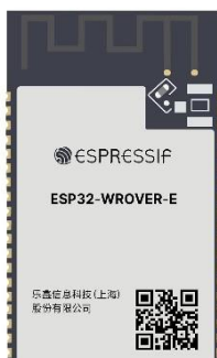
Obrázek 2.2 - Neosazený modul s mikrokontrolerem ESP32 [8]
