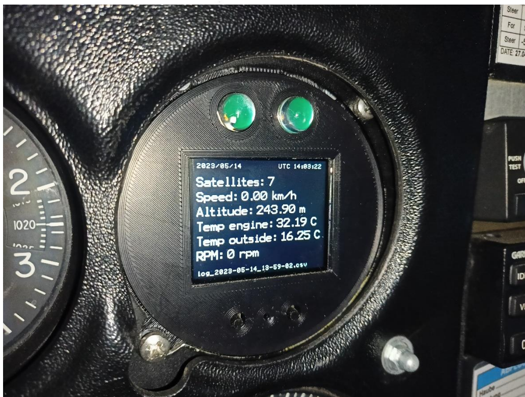
Obrázek 4.1 - Zastavěné záznamové zařízení v letounu DR400/180 OK-VYA
