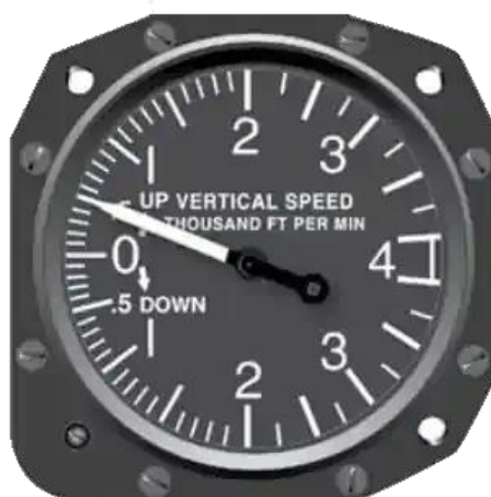
Obrázek 2.23 - Ukazatel vertikální rychlosti letounu (variometr). Kladná výchylky, tj. stoupání vychýlí ručičku nahoru analogicky se směrem pohybu letounu [20]
