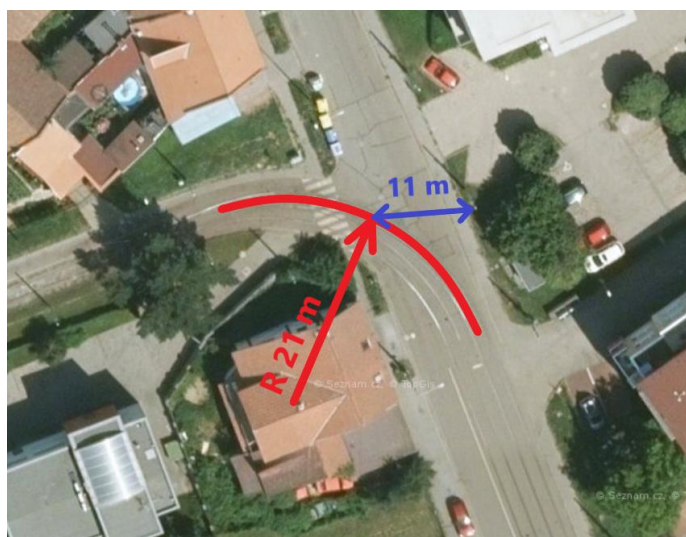
Obr. 4-4 Vzdálenosti v měřeném oblouku, červeně vyznačen rádius pravé koleje (cca 21 m), modře vzdálenost hlukového modulu od středu oblouku (cca 11 m)
