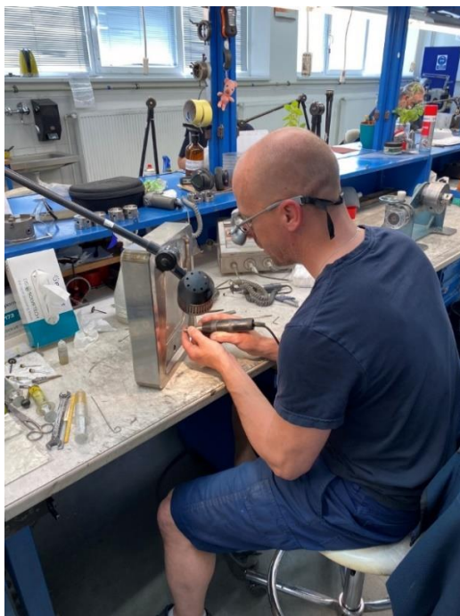
Obr. 59 Leštenie ultrazvukovou leštičkou.
