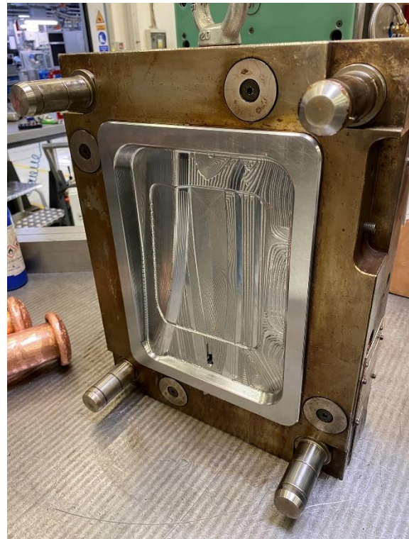
Obr. 53 Kontrola kolmosti strán úchylkomerom. Obr. 54 Kontrola uloženia vložky v ráme formy.
