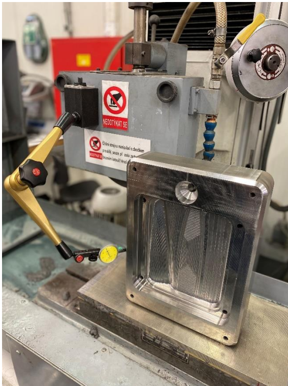
Obr. 53 Kontrola kolmosti strán úchylkomerom. Obr. 54 Kontrola uloženia vložky v ráme formy.
