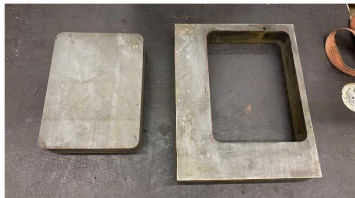
Obr. 51 Vyrezaný tvar vložky formy z pôvodného polotovaru.
