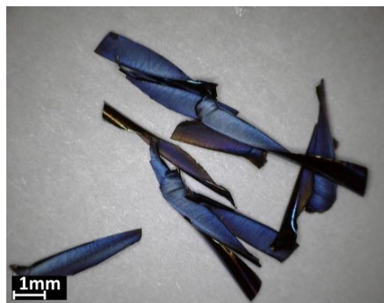
Obr. 34 Trieska vyprodukovaná pri testovaní frézy č. 2.
