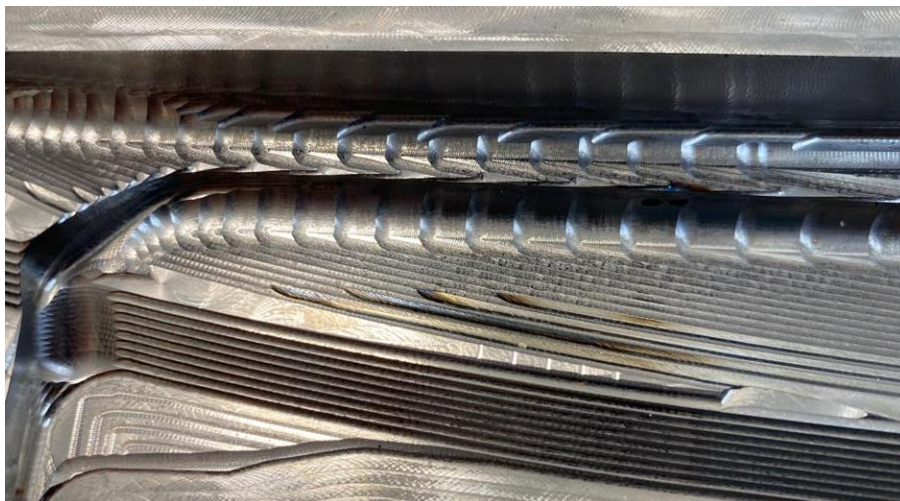
Obr. 43 Stopy na povrchu vzorky po nájazdoch frézy do plného materiálu.
