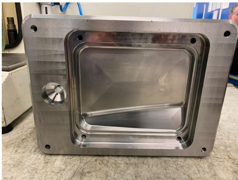
Obr. 55 Dokončená strana chladenia tvarovej vložky.
