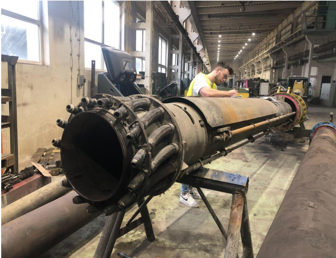
Fig. 16 Burner parameter recording
