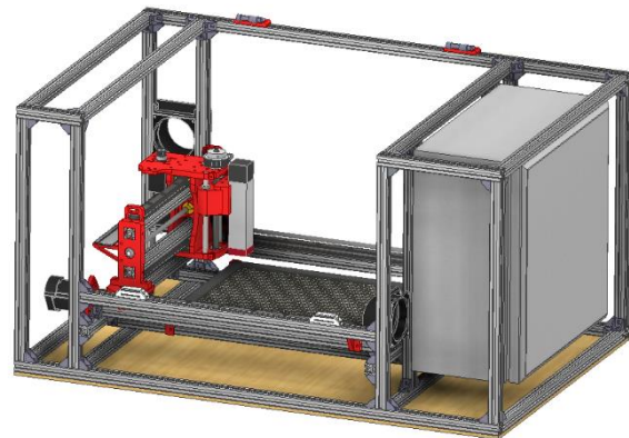
Obrázek 22 Rám stroje s vloženým pohybovým ústrojím
