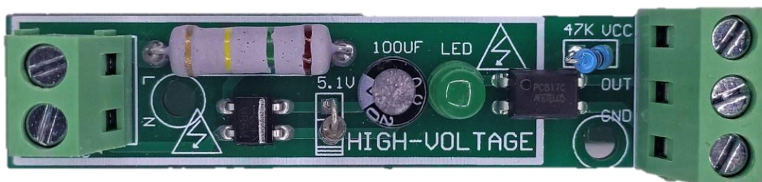
Obr. 14: Modul s optočlenem umožňující detekovat přítomnost síťového napětí na vstupních svorkách (zdroj: autor)
