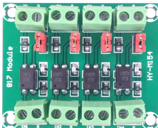
Obr. 13: Modul pro galvanické oddělení pomocí optočlenů PC817C (zdroj: autor)
