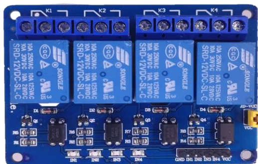
Obr. 21: Reléová deska s optočleny (zdroj: autor)
