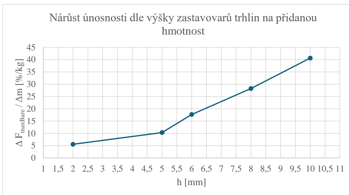
Obrázek 133 Nárůst únosnosti dle výšky zastavovačů růstu trhliny na přidanou hmotnost – upravené
