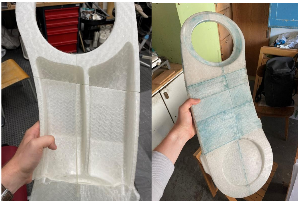
Obr. 45 Skládání, lepení a voskování 3D tištěného modelu
