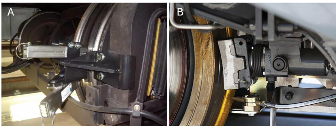
Obr. 5 Spôsoby aplikácie v praxi a) skrutnou pružinou[13] b) stlačeným vzduchom [14]
