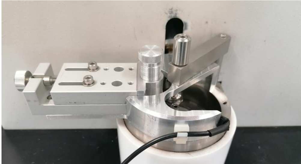
Obr. 27 Hotové zariadenie na aplikáciu tuhých modifikátorov trenia
