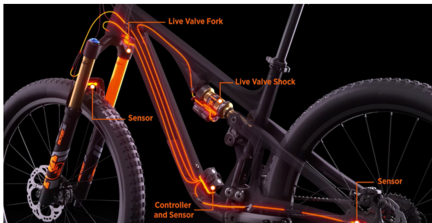
obr. 1-3 Systém celoodpruženého kola FOX Live Valve [7]
