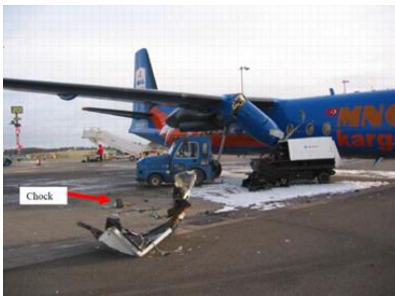
Obr. 37 Poškozený letoun po nárazu do pozemního zdroje GPU [53]
