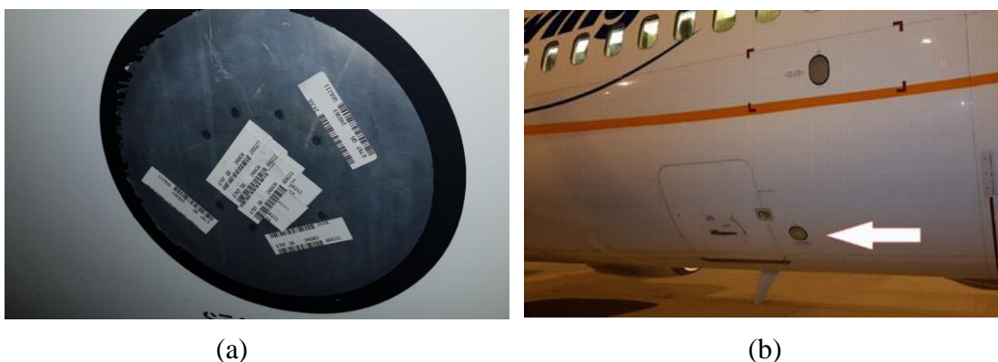
Obr. 30 ) Polepená sonda statického tlaku (a), celkový pohled na umístění statické sondy Boeingu 737 (b) [45]
