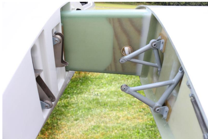
Obr. 6 Kyvný mechanismus automatického spojení řízení mezi trupem a křídlem kluzáku ASK 21 v rozpojeném stavu [13]
