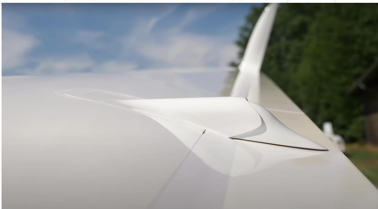
Obr. 2 Mechanismus náhonu flaperonu opatřený aerodynamickým krytem kluzáku AS33 Es [9]
