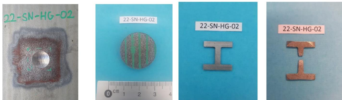
Obr. 32 – Odobratá vzorka z adsorbéra, meracie teleso a výsledok skúšky ťahom [41]
