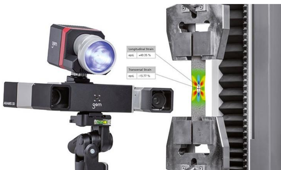
Obrázek 5-4 - Duální kamerový systém DIC Aramis od firmy Trilion [40]
