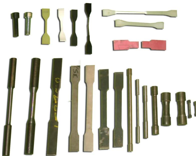
Obrázek 4-1 - Různé typy zkušebních těles pro zkoušku tahem [21]
