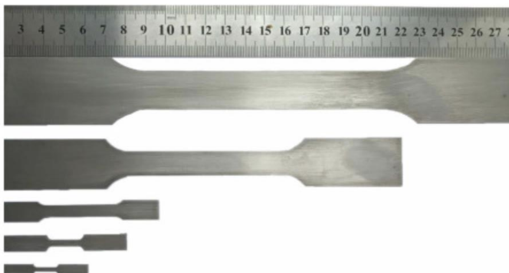
Obrázek 6-5 – Porovnání konvenčních, malých a miniaturních tahových těles [48]
