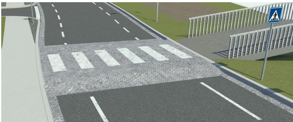
Obr. 24 Přečhod pro chodce sloužící zároveň jako retardér
