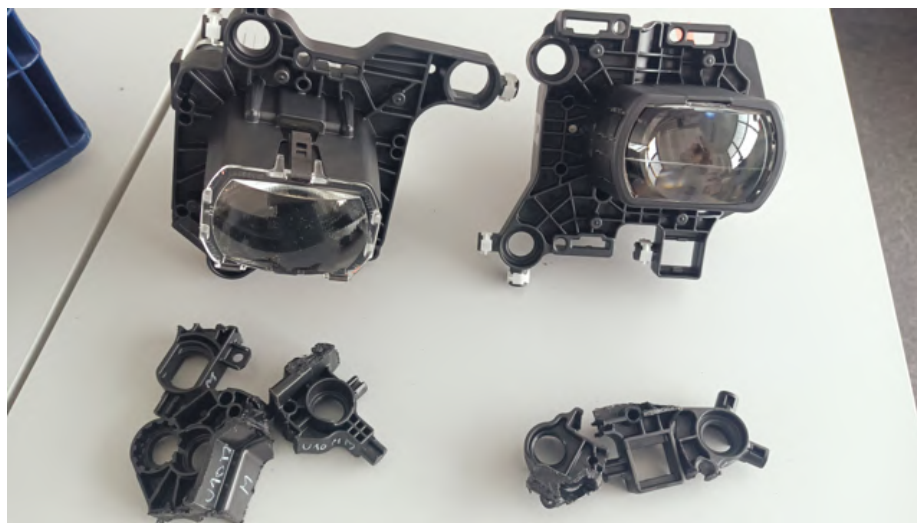
Obrázek 4.1: Měřený carrier frame s moduly (vlevo Matrix , vpravo BiLED )
