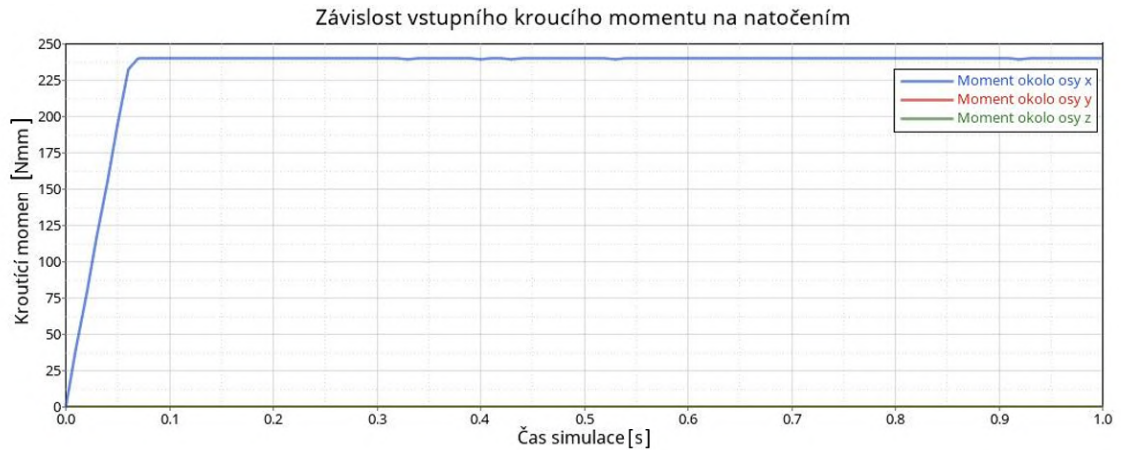
Obrázek 3.10: Výsledky reakčních sil a momentů na konektoru hinge
