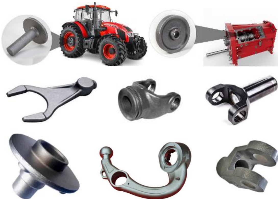
Obr. 1 Ukázky součástí vyrobených zápustkovým kovááním [5; 6].
