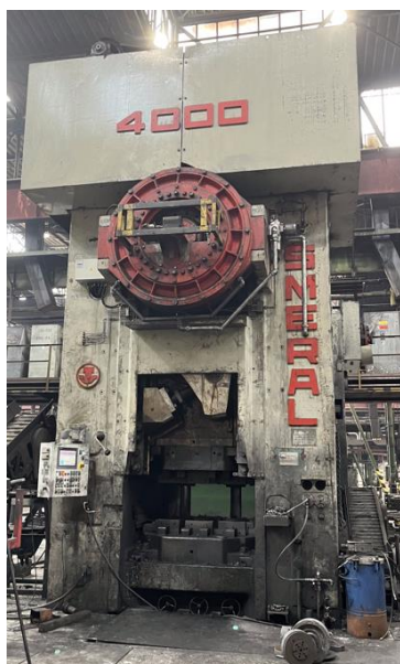
Obr. 95 Ukázka lisu LZK 4 000 včetně nahřívání upnutých nástrojů.
