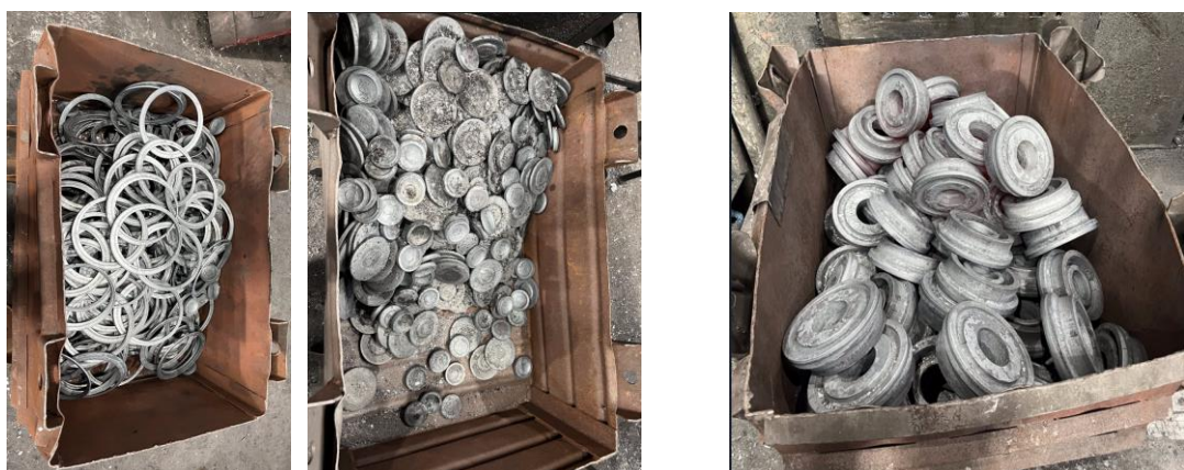
a) odpad – výronky (vlevo) a blány (vpravo).
