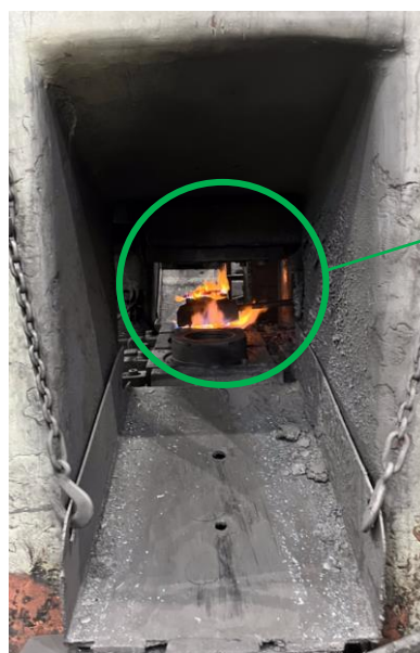
Obr. 95 Ukázka lisu LZK 4 000 včetně nahřívání upnutých nástrojů.
