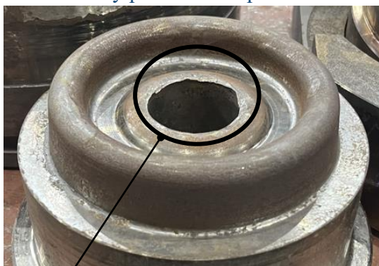
Lehké poškození hrany nástroje při demontáži po zkušební sérii – proběhla oprava
