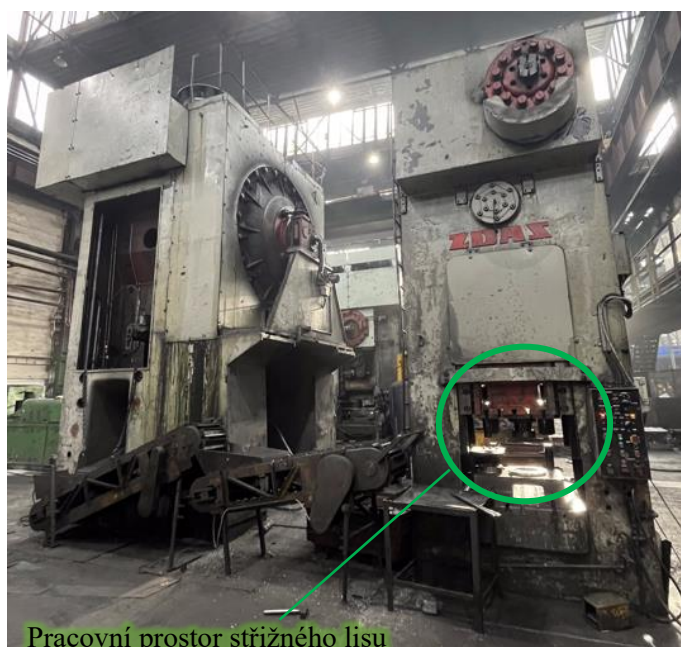
Obr. 97 Vzájemná pozice kovacího a střížného lisu.
