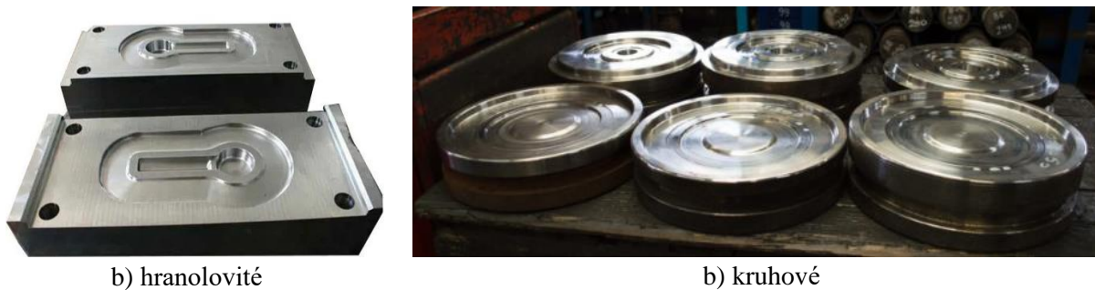
Obr. 33 Příklady tvarů zápustek – hranolovité a kruhové [37].
