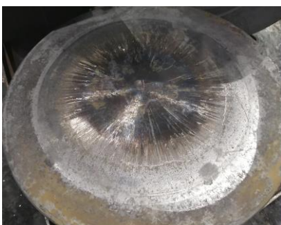
c) vrchní pēchovací nástroj po vykování 2000 kusů – 1op.
