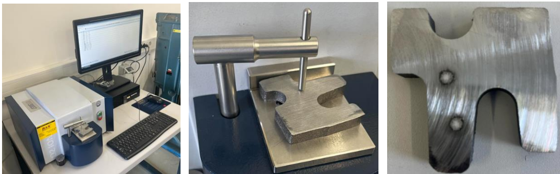
Obr. 113 Jednoduchá kontrola chemického složení – spektrometrie.
