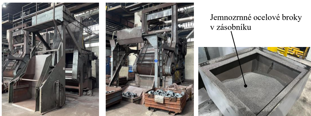
a) ukázka za klidu stroje b) ukázka za chodu stroje c) tryskací médium
