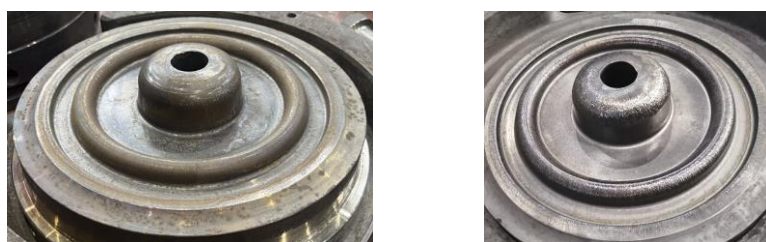
a) vrchní část nástroje po 50 kusech – 2op. b) vrchní část nástroje po 2000 kusech – 2op.
