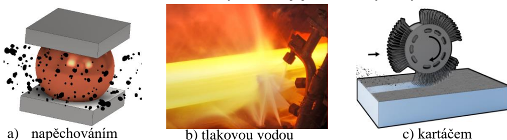
Obr. 30 Různé příklad metod na odstraňování okují [3; 21; 34].
