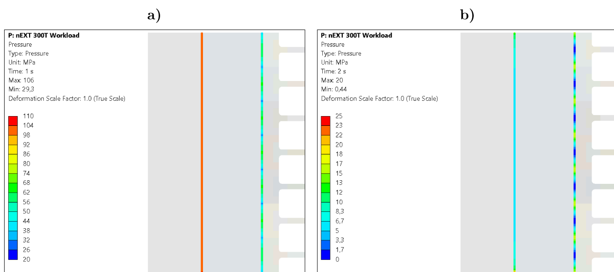
Obrázek 31: Průběhy kontaktní tlaků - aktuální způsob montáže: a) po kompletaci, b) pracovní zatížení.
