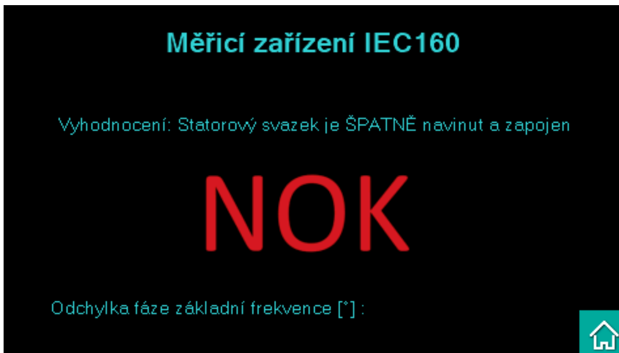
Obrázek 4.22: Zpráva na displeji po změření chybného statoru
