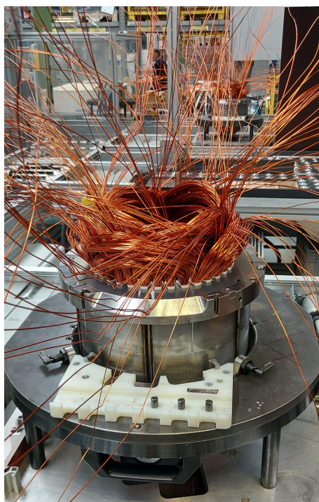
Obrázek 3.1: Statorové vinutí po vtažení statomatem
