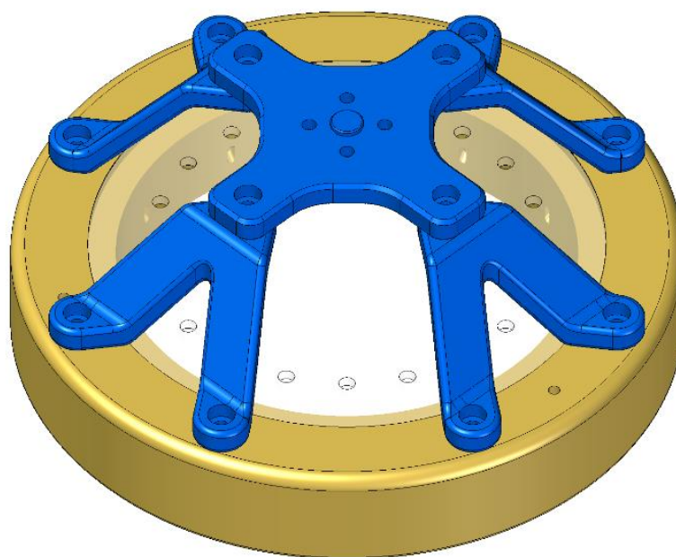
Obr. 29: Finální model prstence s uchycením na manipulátor
