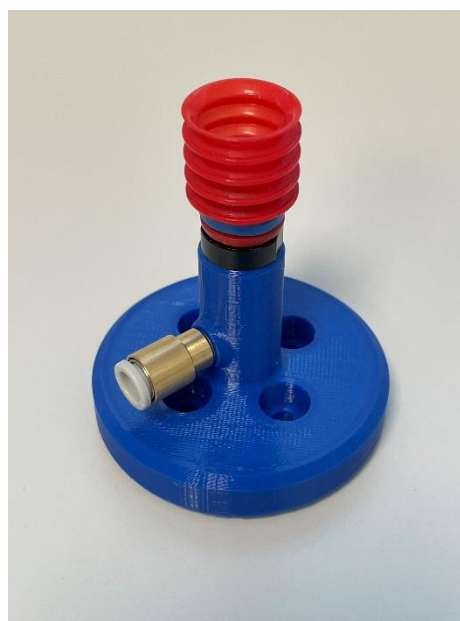
Obr. 4: Vyrobený koncový efektor robota s vakuovou přísavkou
