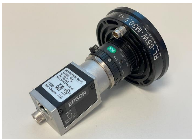
Obr. 33: Sestava kamery, objektivu a kruhového světla
