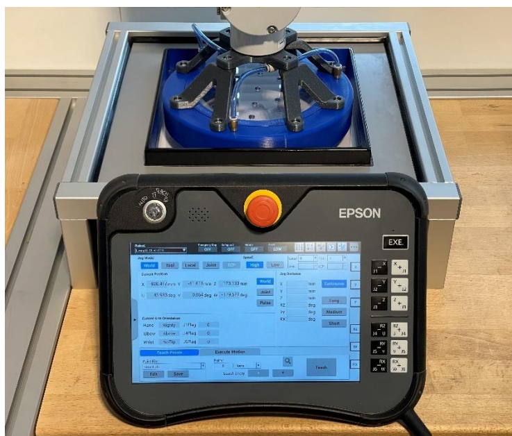
Obr. 34: Pracovní tablet TP3 během nastavování robotické buňky
