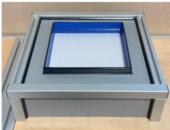
Obr. 38: Odebírací platforma v Minitec konstrukci
