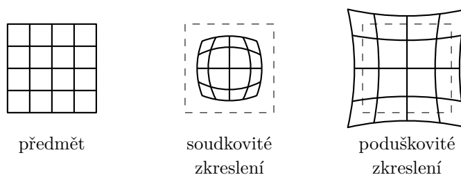
Obrázek 3.4: Zkreslení obrazu. Rozlišujeme dva typy podle toho, jestli se zvětšení pro větší hodnoty pole zmenšuje (soudkovité), nebo zvětšuje (poduškovité). Překresleno podle obrázku v [48, str. 40].
