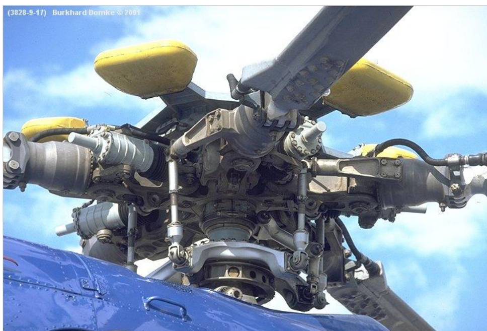
Obr. 2.1.2 Rotorová hlava vrtulníku Mi – 17 [10]
