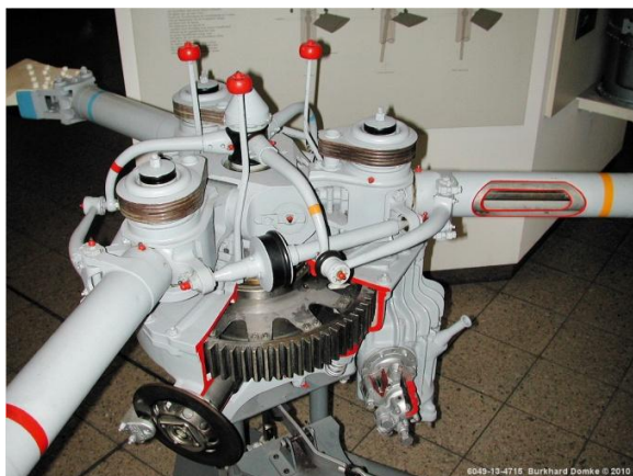
Obr. 2.2.1.3 Rotorová hlava Bristol 171 Sycamore se systémem pavouk [10]
