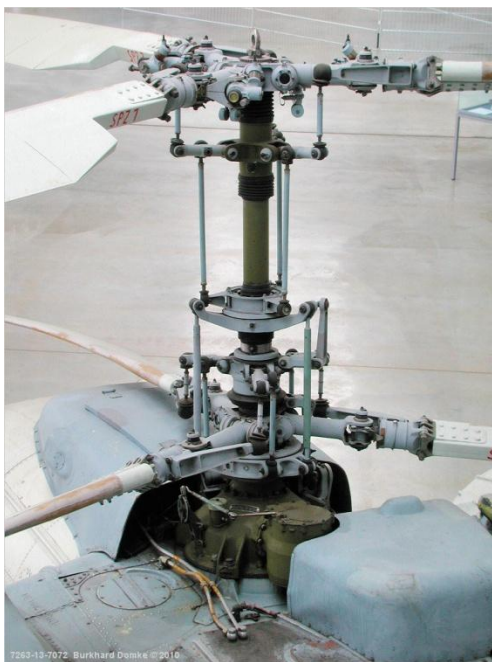
Obr. 2.5.4.1 Rotorová hlava vrtulníku Kamov Ka – 26 [10]
