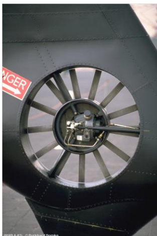
Obr. 2.5.2.2 13lopatkový ocasní rotor vrtulníku Aérospatiale SA 342 Gazelle [10]
