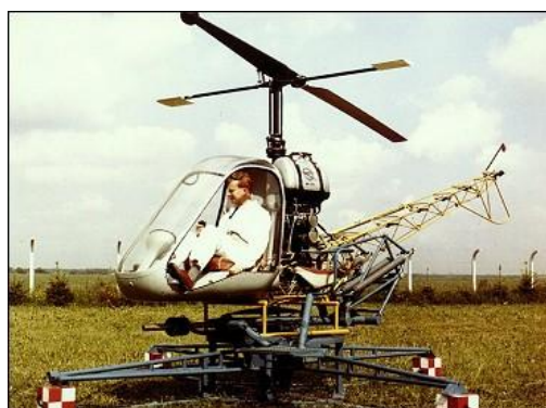
Obr. 2.1.1 Bö – 102 s rotorem s protizávažím [11]
