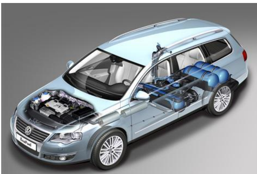
Obr. 13 Uložení nádrží u automobilu Volkswagen Passat FSI EcoFuel [50]
